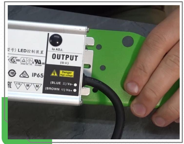
Dazu die Schrauben mit den Unterlegscheiben durch die Öffnungen der Treiberhalterung und durch die Öffnungen des Winkels führen und auf der Rückseite des Winkels mit den entsprechenden Müttern festziehen.
