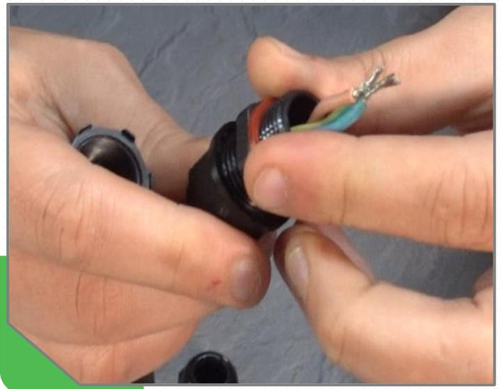
Die offenen Enden der Treiberleitung werden nun in die entsprechenden Öffnungen des Verbindungsstück eingeführt. Dazu die Schrauben am Verbindungsstück leicht lösen um das Einführen zu erleichtern. Sind die Adern eingeführt, werden nun die Schrauben wieder festgezogen, um das Herausrutschen der Adern zu verhindern.
