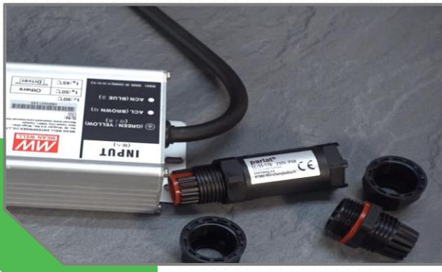
Nun wird die äußere Hülle der Kabelmuffe, über die zu verbindenden Enden geführt.
